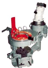
Применяются для механизации операций свинчивания и развинчивания, центрирования, захвата, удержания на весу колонны насосно-компрессорных труб при текущем ремонте скважин, эксплуатируемых всеми видами оборудования, включая электропогружные насосы.
