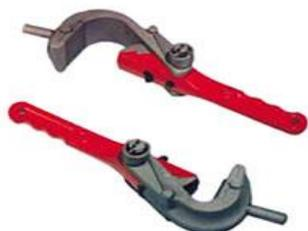
Применяются для проведения монтажно-демонтажных работ, при спускоподъемных операциях на скважинах насосно-компрессорных труб, с помощью ключа-автомата АПР-2 или механического ключа КМУ-50.
