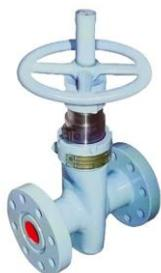
Задвижка ЗМС65 — полнопроходная, параллельная, с однопластинчатым шибером и выдвижным шпинделем предназначена для работы в качестве запорного устройства устьевого оборудования и на трубопроводах, транспортирующих воду, нефть и газ с температурой рабочей среды до +120 °С.
